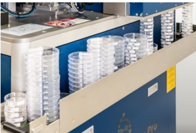
Abbildung 3: Das umlaufende Auslaufband transportiert die gestapelten Petrischalen zur Vorderseite des Systems
